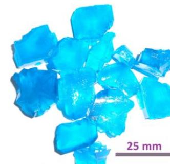
Семейство полученных формиатов меди в разных полиморфных модификациях и с разным содержанием кристаллизационной воды
