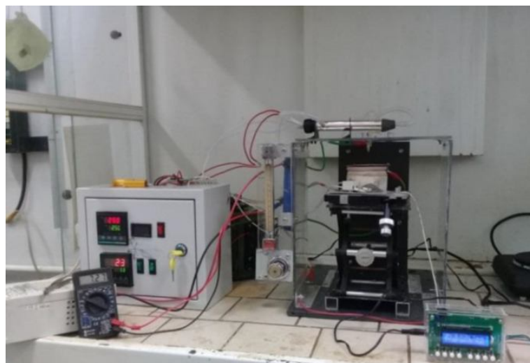
Макет установки электростатического распыления для получения оксидных плёнок
