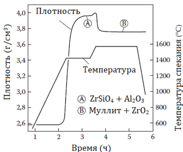
Рисунок 11.57. Схема реакционного спекания порошковых смесей ZrSiO 4 -Al 2 O 3 . В точке А с помощью рентгеноструктурного анализа обнаруживаются фазы ZrSiO 4 и Al 2 O 3 ; в точке В обнаруживаются фазы муллита и ZrO 2 (реакция образования муллита завершена) [94]
