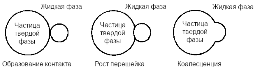
Рисунок 10.30. Схематическое изображение коалесценции мелких и крупных зерен
