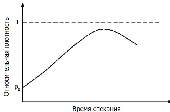
Рисунок 12.16. Характерный вид зависимости плотности от длительности спекания порошковой заготовки, содержащей в порах газ с ограниченной растворимостью. Зависимость имеет максимум, обусловленный наличием захваченного порами газа
