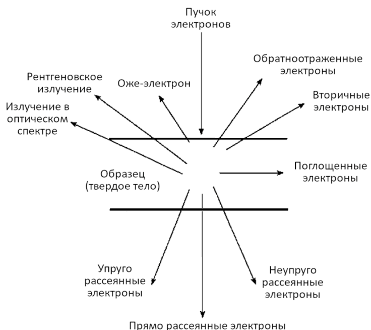
Рисунок 3.18. Излучение, возникающее при взаимодействии пучка электронов с твердым телом
