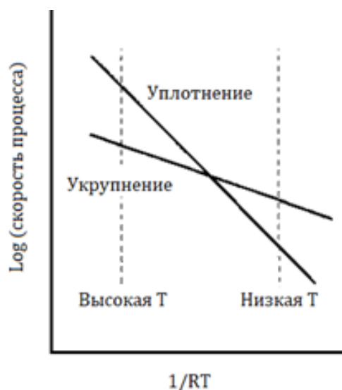
Рисунок 9.52. В условиях, когда процесс уплотнения имеет более высокую энергию активации, чем процесс роста зерна, использование высокой скорости нагрева до высоких температур (быстрый обжиг) может быть полезным для достижения высокой плотности керамики
