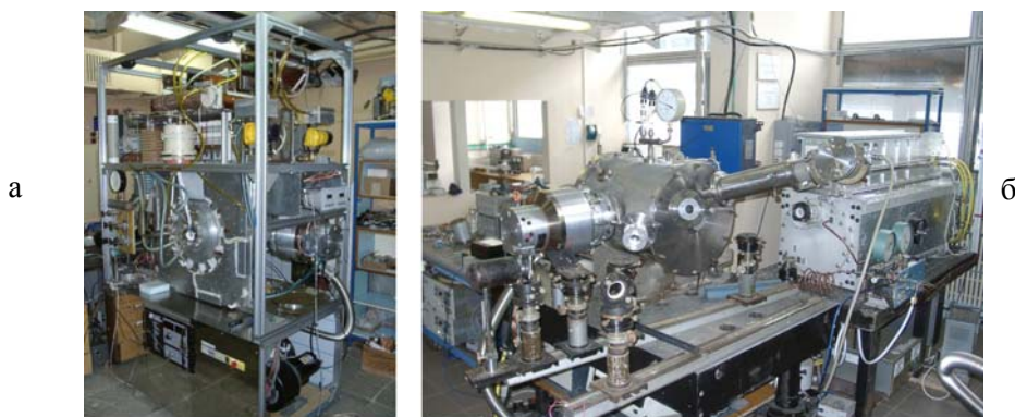
Рис. 13 Источники с использованием плазмы Z-пинча (а) и с использованием вакуумной искры в парах металла (б).
