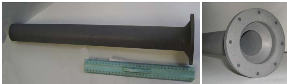
Рис. 15 Длинномерная деталь из пористого нанобериллия. Длина трубчатой части – 600 мм, диаметр – 40 мм, плотность – 0,27 г/см 3 . Диаметр фланца – 108 мм, толщина – 8 мм, плотность – 0,40 г/см 3 . Прочность при сжатии материала: в трубчатой части – 24 МПа, во фланцевой части – 45 МПа.
