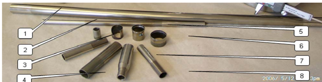
Рис. 17 Трубчатые переходники и биметаллические трубы с поперечной слоистостью
