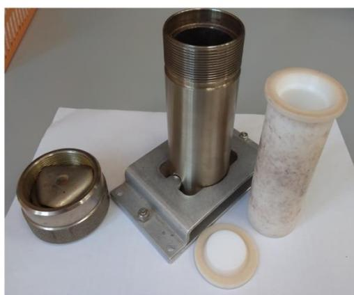
Рисунок 2.4 – Установка для гидротермального синтеза: тефлоновый стакан и стальной автоклав объемом 50 см<sup>3</sup>
