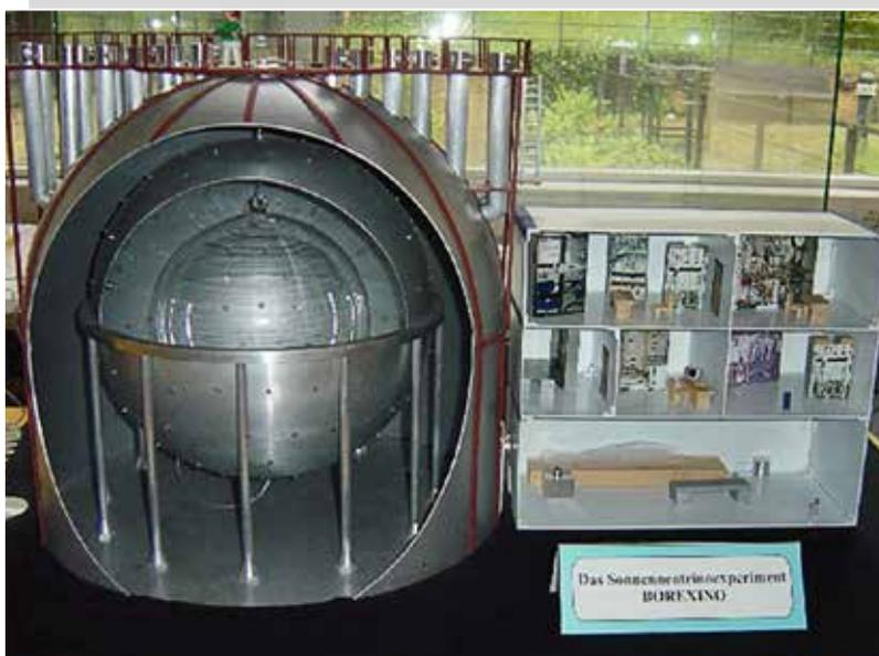
▲ Установка Борексино подобна луковице: внутри сам детектор, заполненный светящейся жидкостью-сцинтиллятором. Его окружает стальная сфера, на которой закреплены фотодетекторы. Вся эта система помещена в бак с водой
