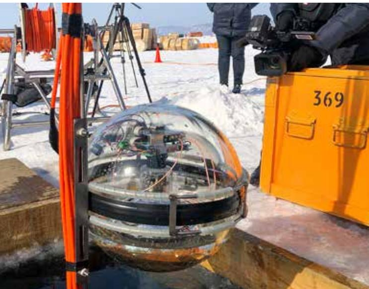
◀ ▼ К каждой гирлянде, погружаемой в озеро, присоединяют 36 оптических элементов. Такой элемент представляет собой прозрачный шар, в который заключены фотодетектор и электроника, необходимая для передачи полученного сигнала на материк
